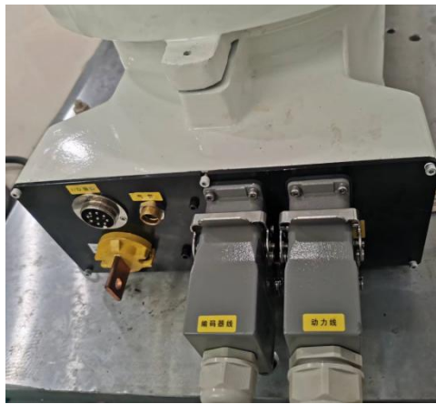
图 4.7 拆除后端盖内六角螺丝
