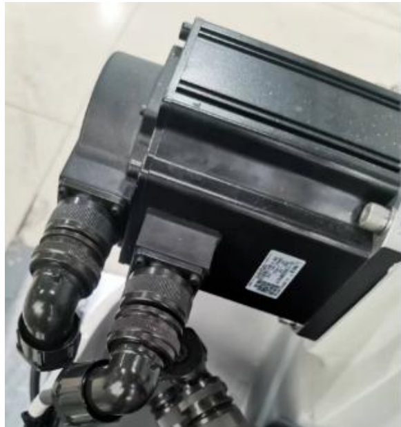
图 4.2 本体电机接头检查
