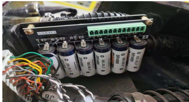
图 4.10 更换电池并用万用表测量电压
