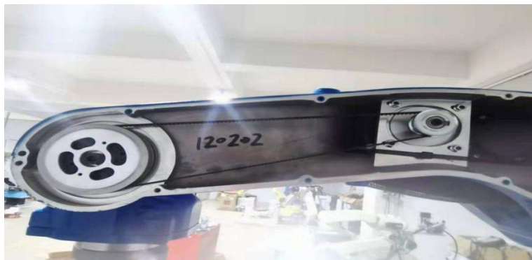
图 4.12 手腕同步带结构
